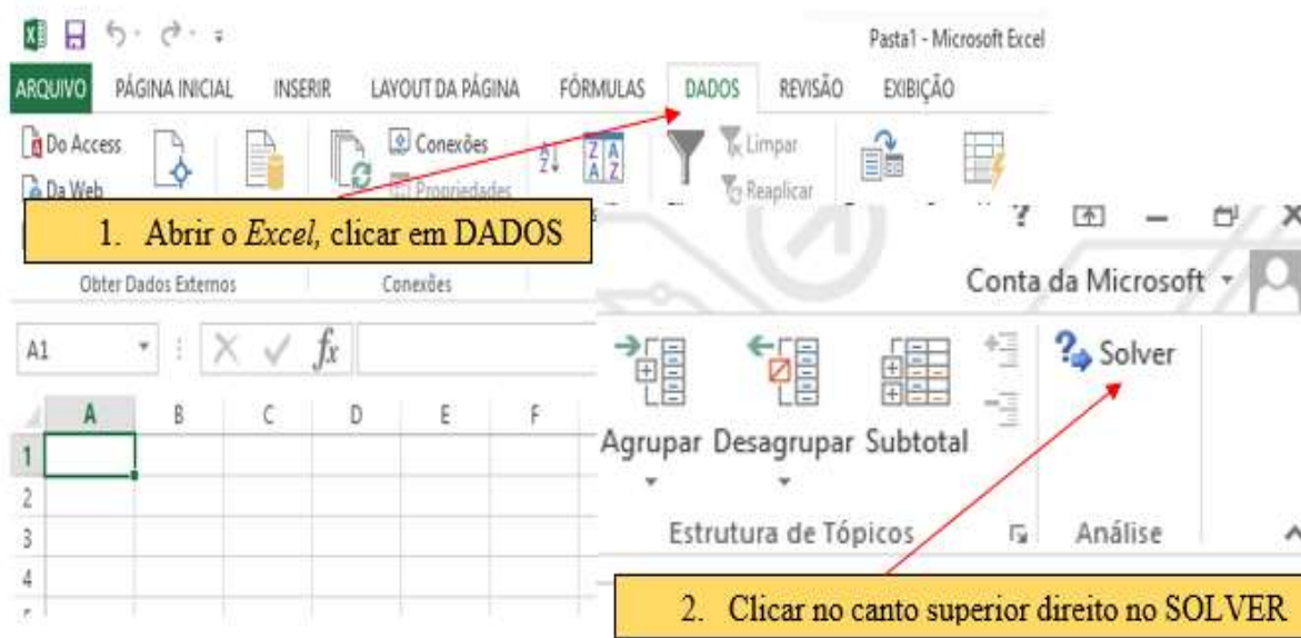
Figura 30: Print da aba do Excel com os passos para acessar o recurso solver , (1) abrir o Excel e clicar em DADOS, em seguida clicar no canto superior direito em SOLVER (2).
