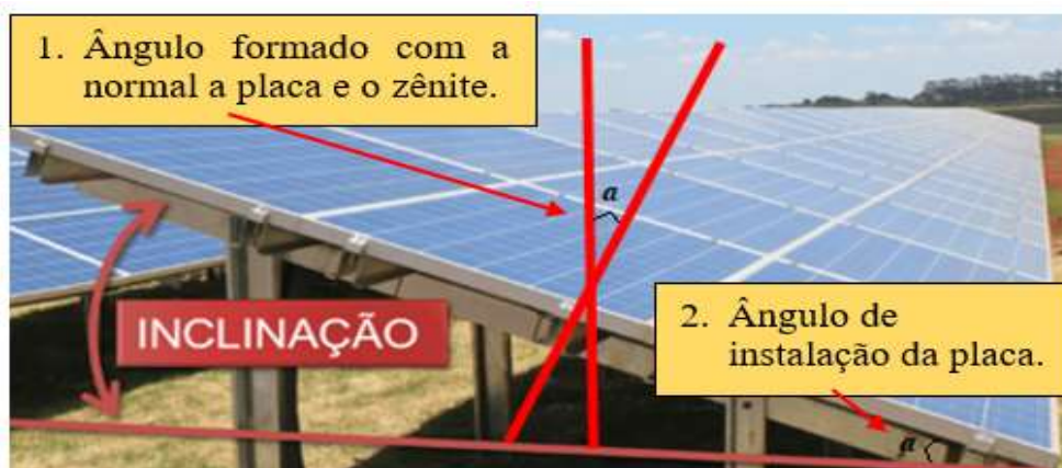
Figura 44: Ângulo da placa fotovoltaica com a normal e o zênite
