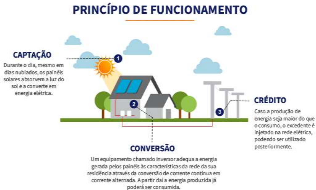
Figura 03: Princípio de funcionamento de um sistema fotovoltaico
