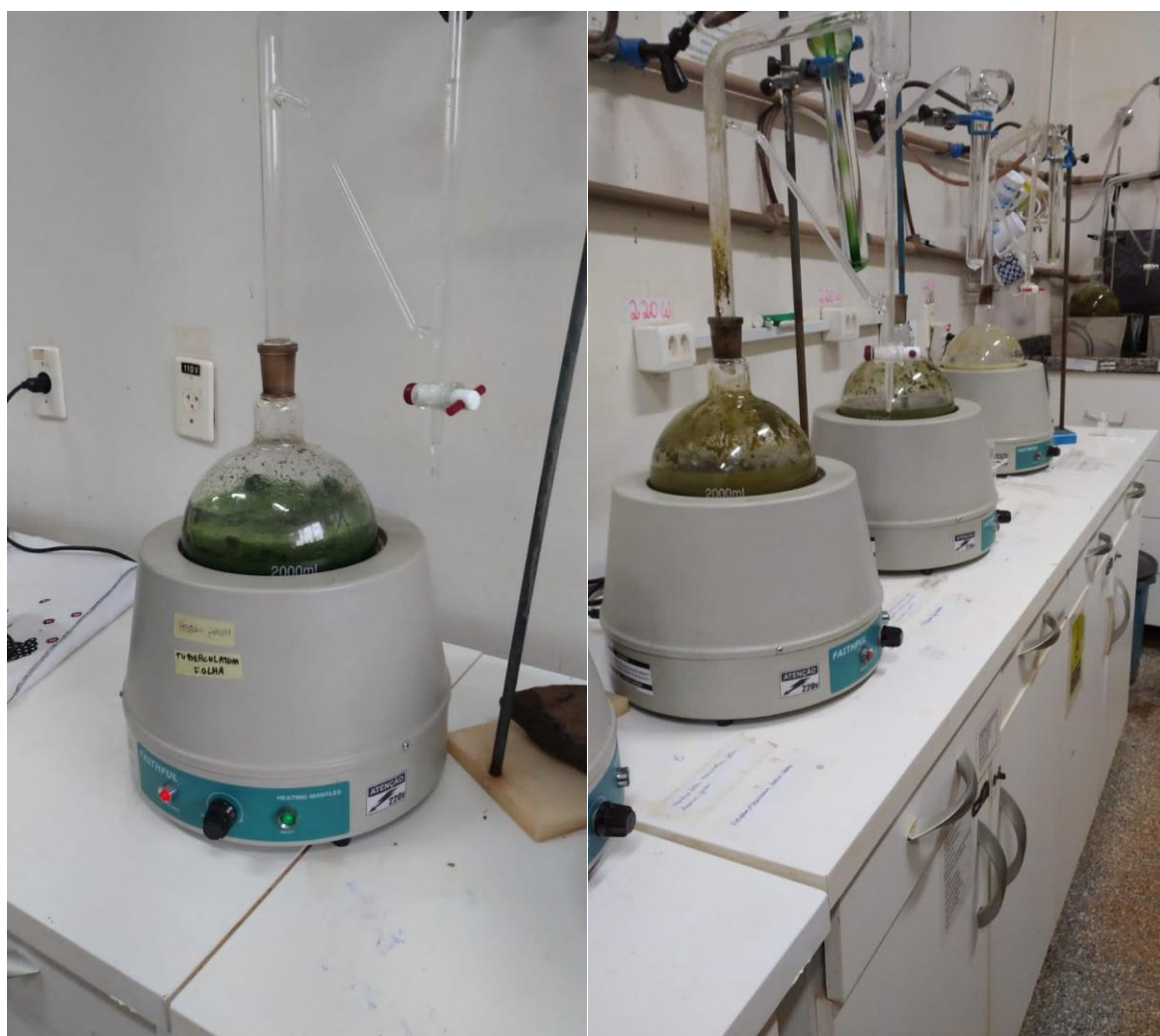
Figura 11. Imagens do aparelho de Clevenger utilizado no processo de hidrodestilação para extração dos óleos essenciais das espécies Piper arboreum e Piper fuligineum .
