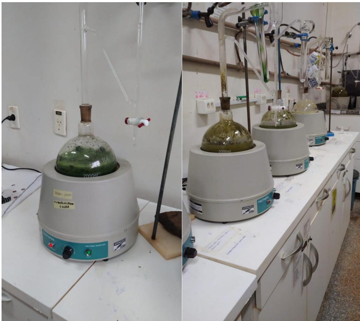
Figura 3. Aparelho de Clevenger utilizado no processo de hidrodestilação para extração dos óleos essenciais de Piper arboreum e Piper fuligineum .
