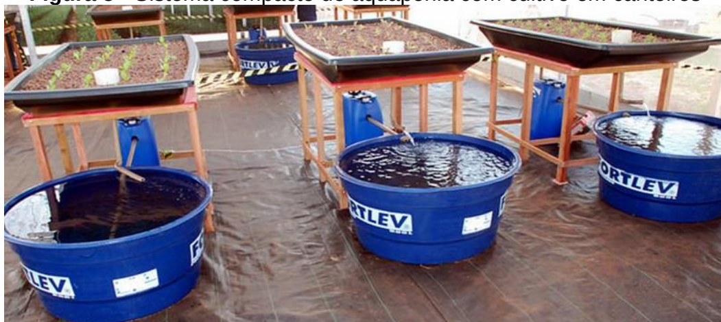
Figura 5 - Sistema compacto de aquaponia com cultivo em canteiros
